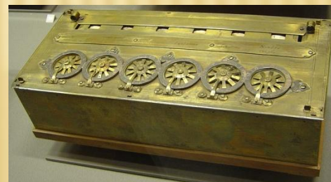
Pascaline – mechanická sčítačka a odčítačka
