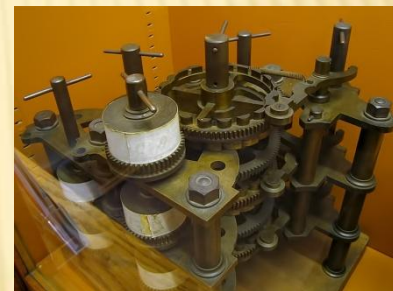
Část Babbageova diferenčního stroje, který, za použití součástek nalezených v dílně, sestavil jeho syn.
