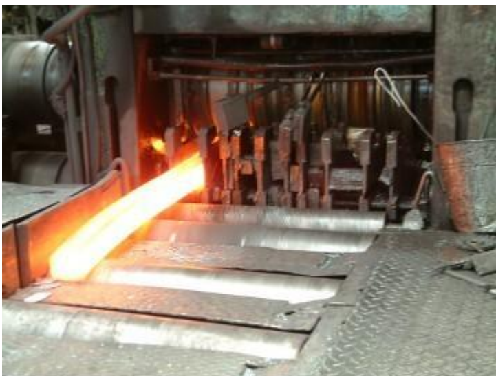
Válcování čtvercové tyče za tepla
