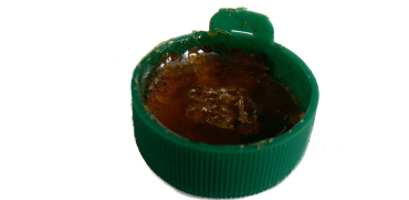
Kalafuna – prostředek používaný při pájení, váže k sobě nežádoucí látky vznikající při pájení, umožňuje vznik pevného pájeného spoje
